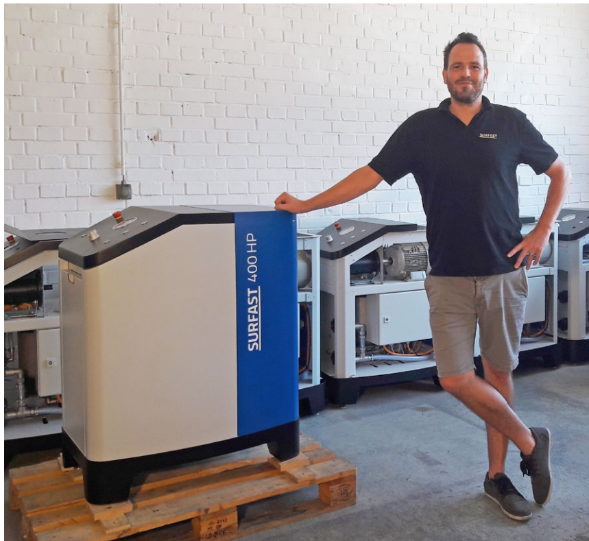
Herzstück des Systems: Geschäftsführer Philipp Roth mit jener Prozesseinheit, in der das Reinigungsgemisch hergestellt und auf den nötigen Druck gebracht wird.
